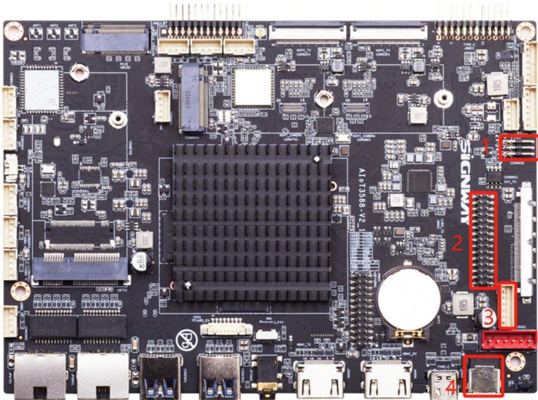
1.屏压：根据选用液晶屏屏压将跳线帽插在对应屏压的条线上，如图由上到下依次是 12V， 5V， 3.3V。**屏电源选错将会烧屏！**
