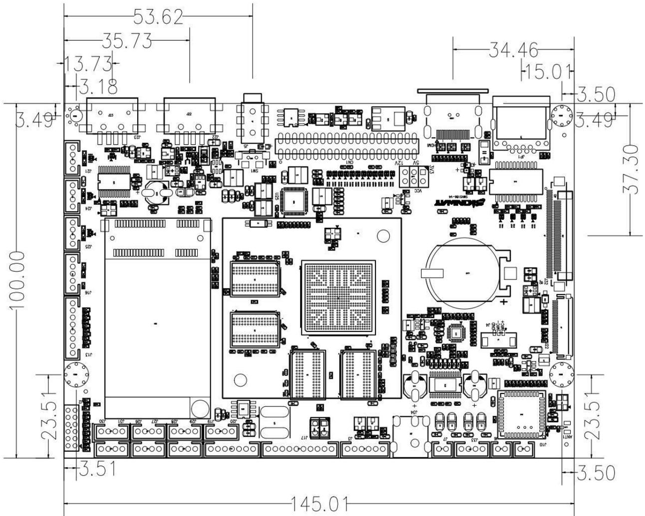
长：145mm；宽：100mm；正面最大高度：9mm；反面最大高度：4mm；板厚 1.6mm，螺丝孔径：Φ3.5mm
